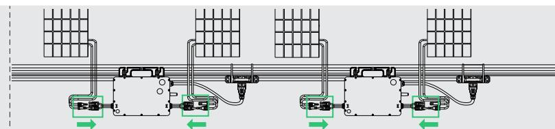
**B)** Conecte los cables de CC de los módulos FV al lado de entrada de CC del microinversor.
